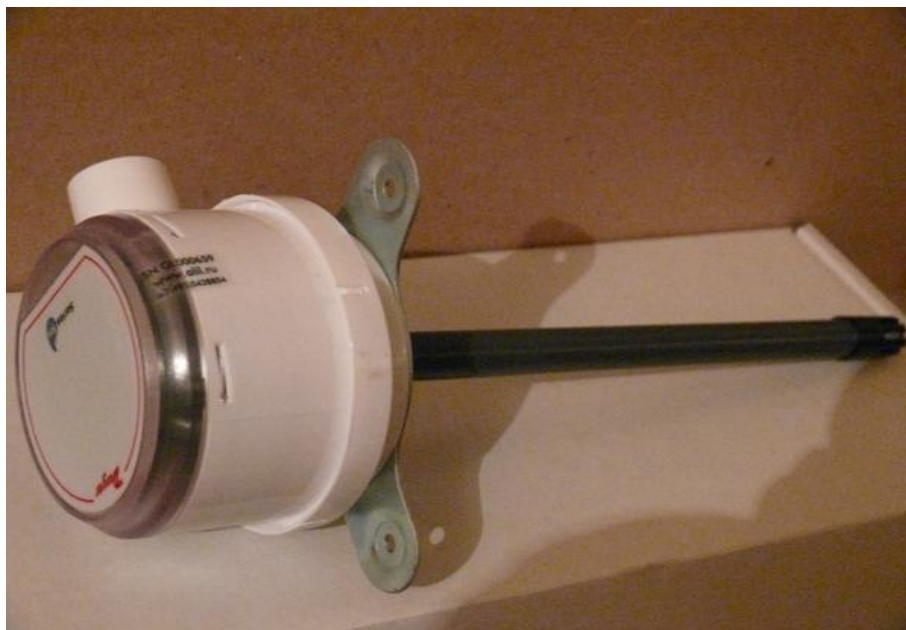
Рис 1.2 Модификация RHP, исполнение 1 (монтажа в канале)
